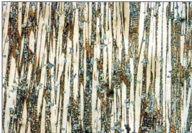
*Микроструктура износостойкого слоя состоит из строго ориентированных твердых фаз в прочной матрице*
