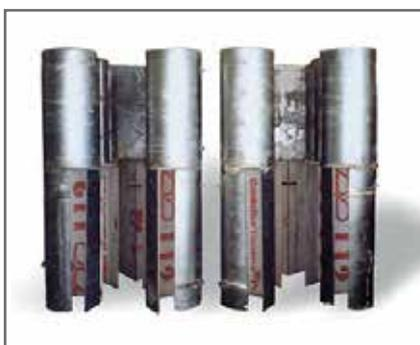
Трубы циклона в вентиляционной системе эксгаустера
