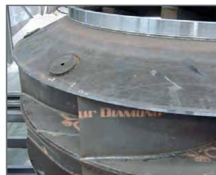
Крыльчатка ротора эксгаустера
