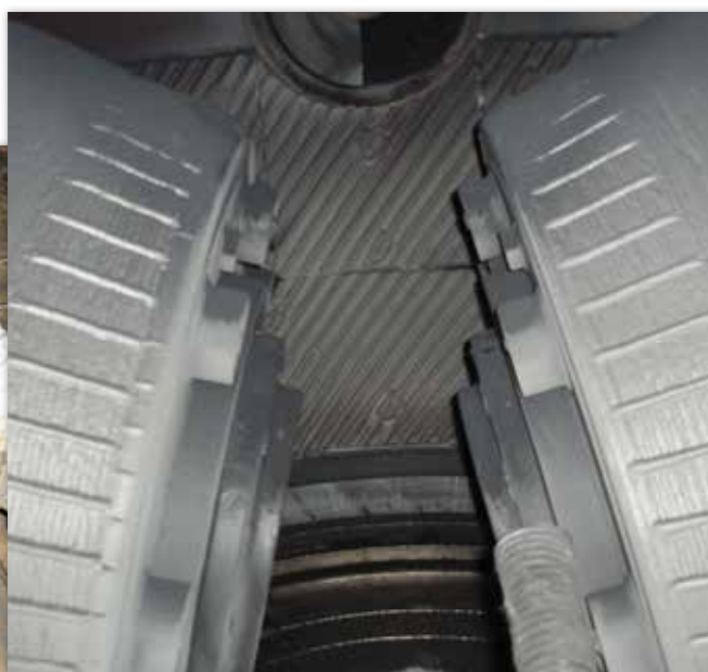
Ролики мельницы Loesche для нефтяного кокса
