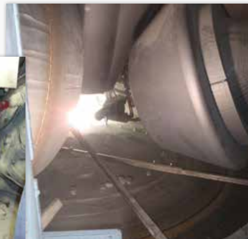
Мельница Loesche LM 46.2+2, одновременная наплавка 2 роликов и стола
