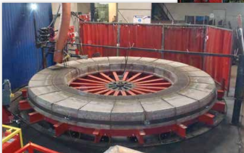
Восстановление сегментов стола до 50 тонн
