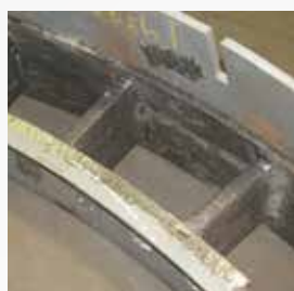
Сегмент кольцевого сопла с защитой из наносплава
