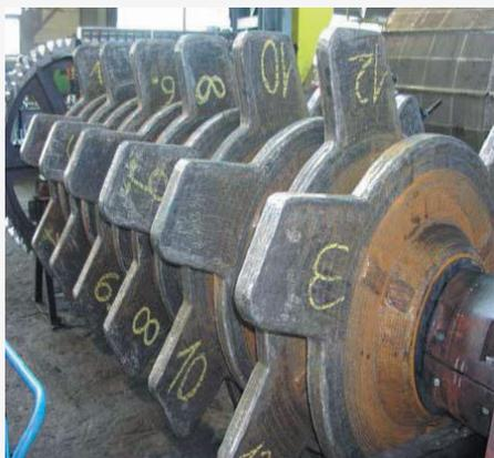
**Ротор дробилки агломерата**
